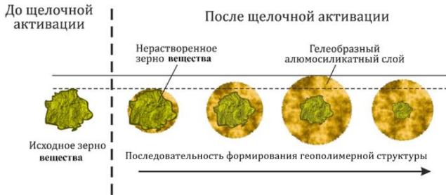
Рис. 6 – Механизм образования системы «растворяемое зерно алюмосиликата – гелеобразный слой» в процессе щелочной активации алюмосиликатного компонента
